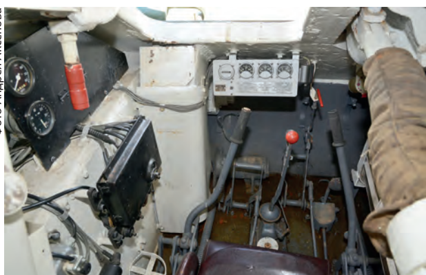
Отделение управления — рабочее место механика-водителя САУ.
